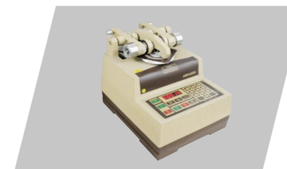
Test der Nutzungsklassen mittels Taber Abraser
